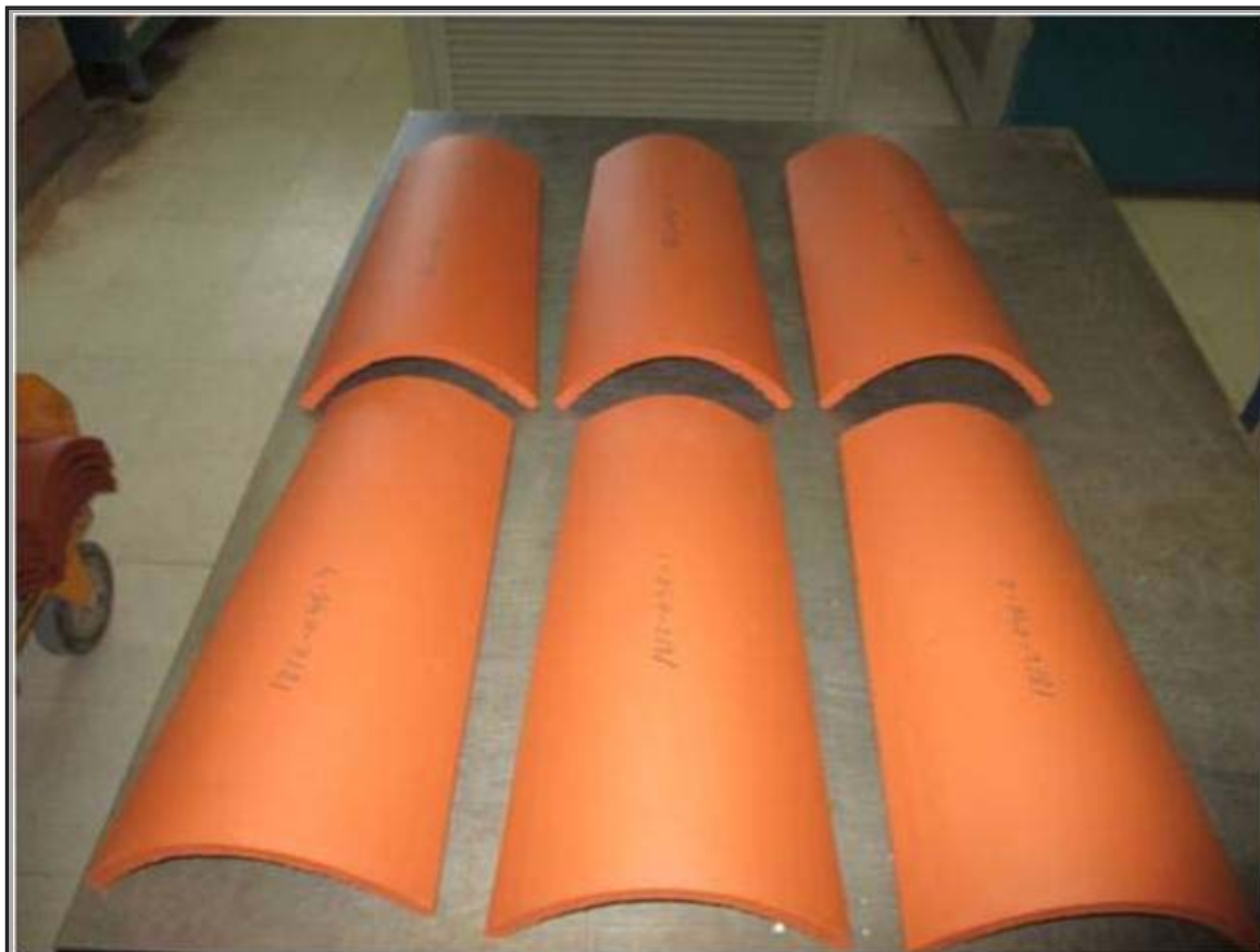
Fotografía 1: Aspecto de las tejas después de 500 ciclos de hielo
